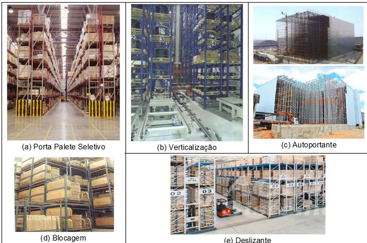
Figura 6.3 – Sistemas de armazenagem considerados.
